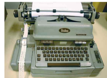
De offline-terminal X1 van Electrologica, met links de ponsstrook
